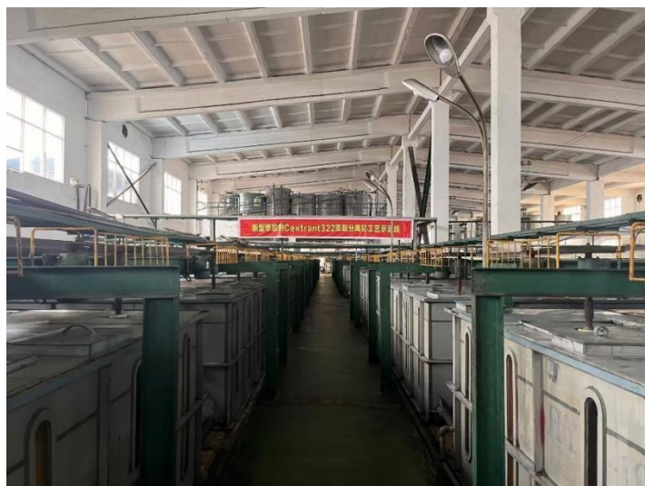
图 2 年处理 3000 吨离子型稀土矿中钇分离生产线
