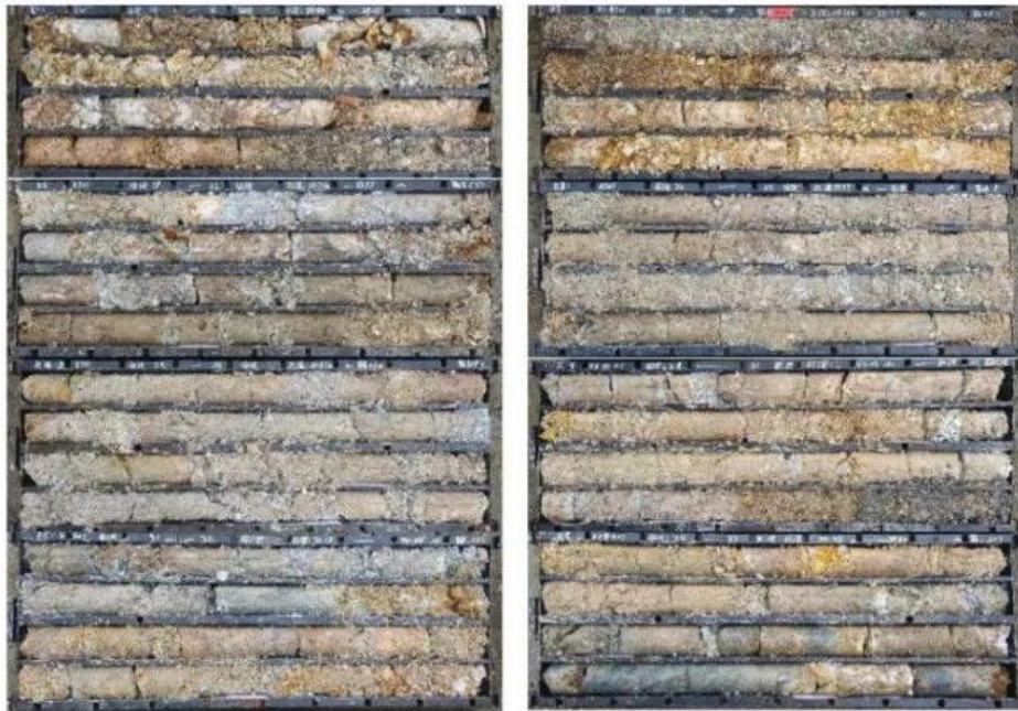
图4 环单沟找矿靶区 ZK4501 钻遇厚大隐伏稀土矿体
