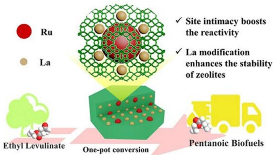
大连化物所构筑分子筛双功能催化剂实现高效制备生物燃油
