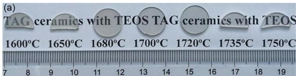
铽铝石榴石 (TAG) 磁光陶瓷的实物照片
